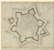
Trazo de fortificación hexagonal para Olivença por Nicolás de Langres (hacia 1650) en su manuscrito de dibujos conservado en la Biblioteca Nacional Portuguesa. No es exactamente regular, aunque se aproxima mucho con dimensiones de lado exterior
