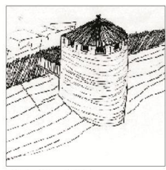
Cubo / Torre TIPO que inicialmente se construye separada del recinto amurallado, sobre la zona inundada de agua, y se conecta con una pasarela movil
